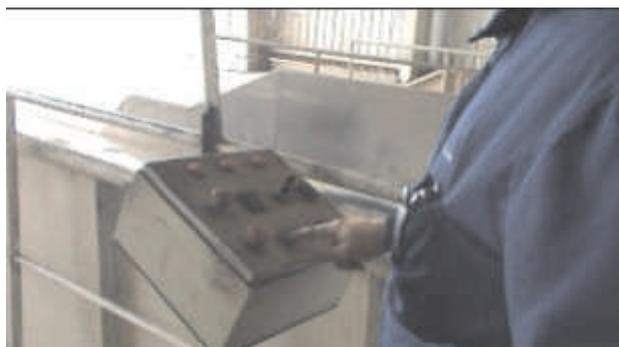
**Fig. 3. Tablero para manejar la plataforma volcadora de acoplados**
